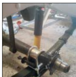
Les suspensions arrière adoptent un kit d'amortisseurs Spax.
