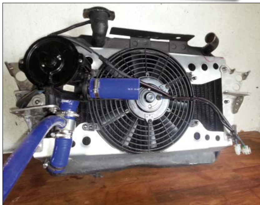
Pour refroidir le tout, un radiateur en aluminium doté d'un gros ventilateur est prévu.
