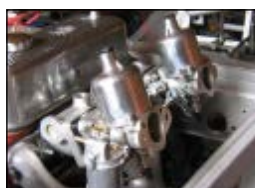
Les deux carburateurs SU HS6 alimenteront la mécanique.
