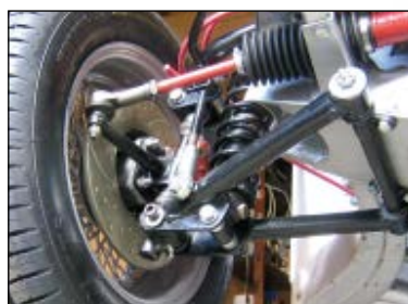
A l'avant, kit Hoyle's avec barre de stabilisation.
