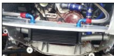
Le bon refroidissement étant mon obsession, un radiateur d'huile a été prévu.
