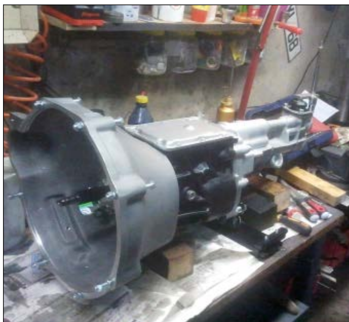
Il sera accolé à une boîte cinq vitesses d'origine... Ford Sierra. Aïe ! Les puristes n'apprécieront pas.
