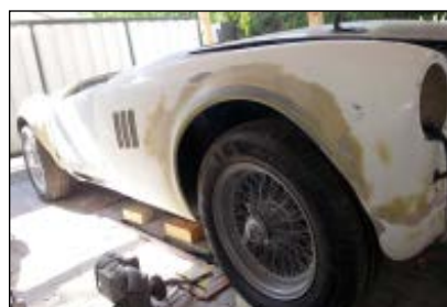
Les ailes sont un tout petit peu élargies pour bien recouvrir les nouvelles roues.
