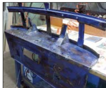
Le berceau avant est passé au Ferose antirouille.
