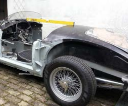
Les ailes sont un tout petit peu élargies pour bien recouvrir les nouvelles roues.
